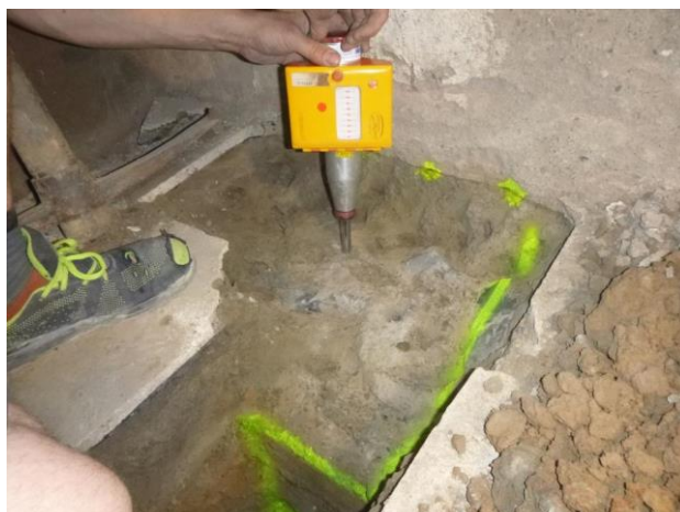
Měření hloubky základové spáry od podlahy ve sklepě.
